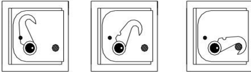
Hình 3.6 - Nguyên tắc cấu tạo và hoạt động của khóa cam
